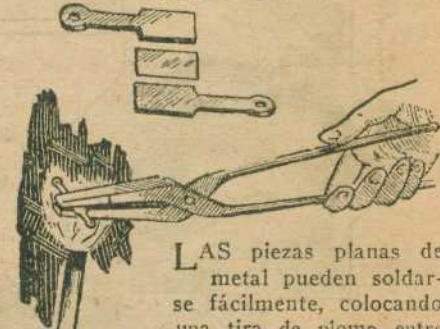
LAS piezas planas de metal pueden soldarse fácilmente, colocando una tira de plomo entre ellas con algún fundente y colocando el conjunto en la llama, sostenido por unos alicates en la forma que ilustra el grabado.
