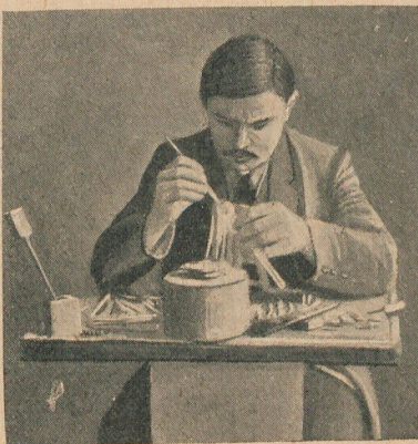
Fig. 1.—Soldadura del iris sobre la esclerótica con la lámpara de esmaltador. A la extremidad izquierda se ve la caja de recocer.
